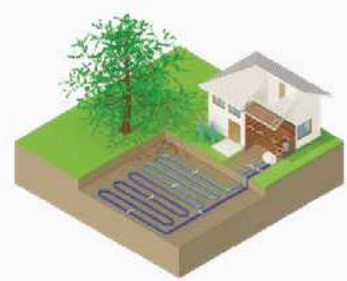
Pompe à chaleur sur capteurs enterrés horizontaux
