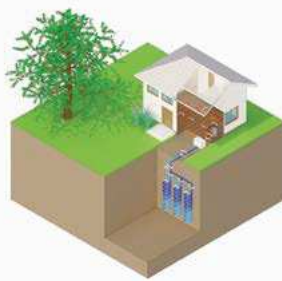
Pompe à chaleur sur corbeilles géothermiques
